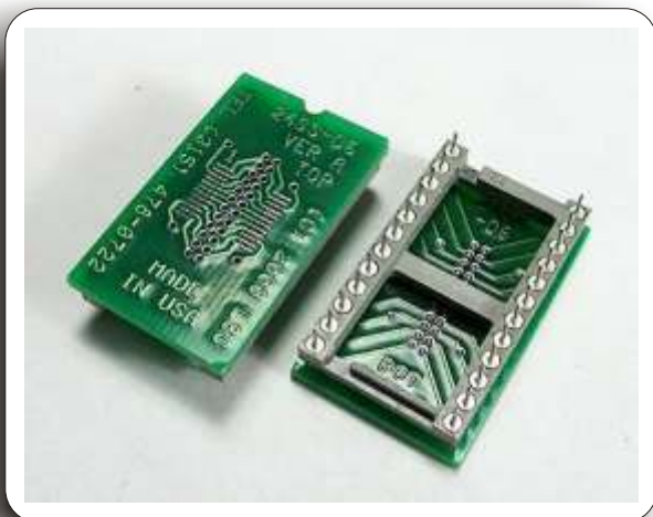
Una plaqueta adaptadora de encapsulado SMD a Through hole
